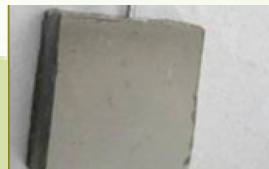
Bagasse ash filter module
